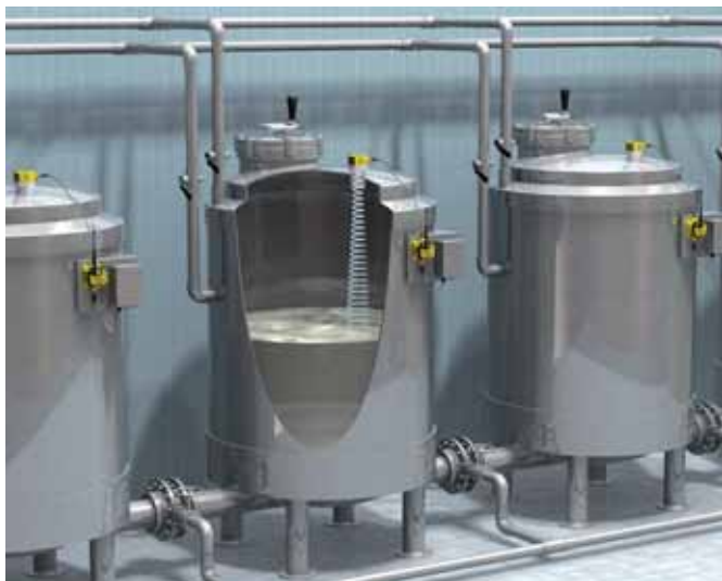
I livelli di fluido in più serbatoi possono essere monitorati simultaneamente da sistemi wireless utilizzando lo spettro espanso a salto di frequenza (Frequency Hopping Spread Spectrum, Fhss)
