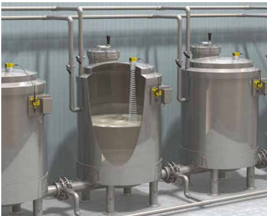
FIGURA 3 - Os níveis de fluido em tanques múltiplos podem ser monitorados simultaneamente por sistemas wireless com o Espectro de Dispersão por Salto de Freqüência (FHSS).
